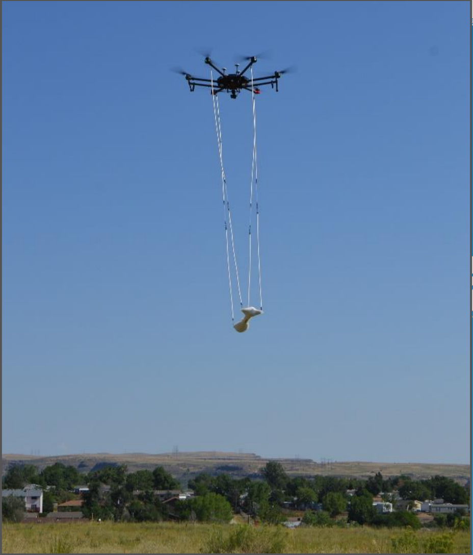
sUAS Aeromagnetic Survey August 3, 2017
